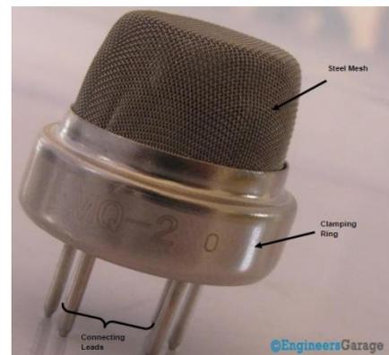
Figure 4: LPG GAS Sensor
